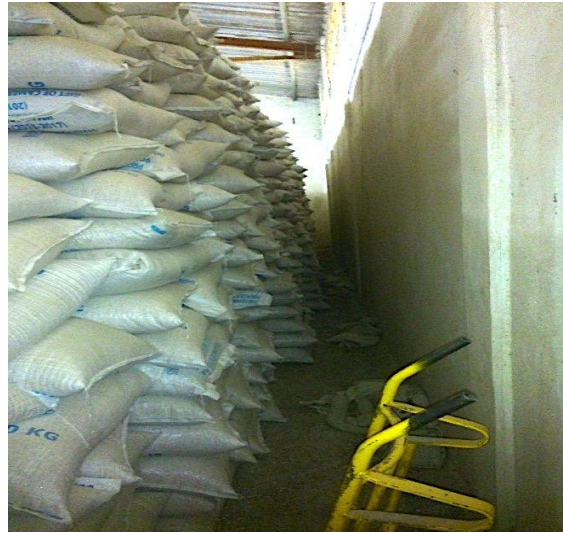
Image 2 : distance entre mur et pile
